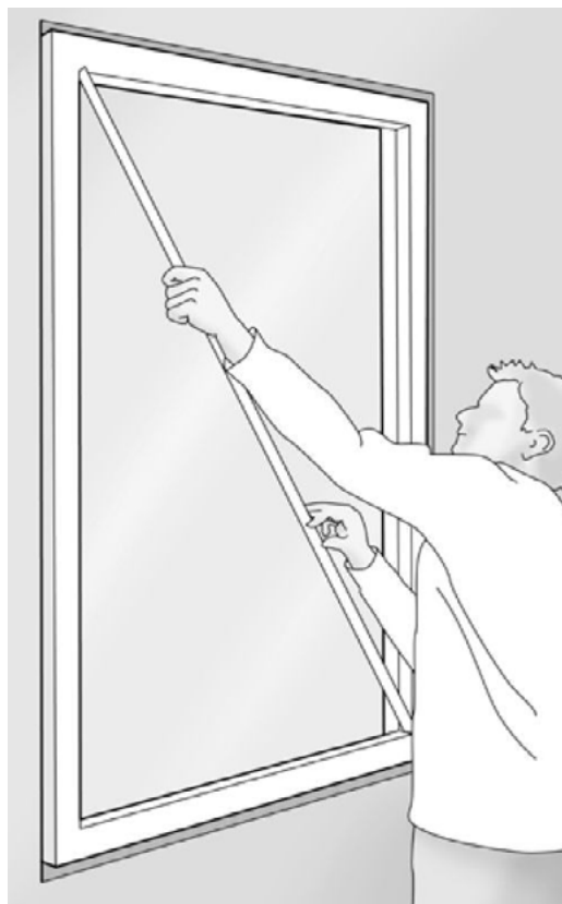
Fig 30. Diagonalmått skall vara lika vilket garanterar ett bra montage
