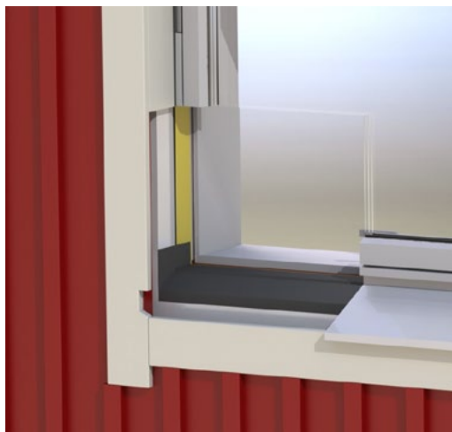
Fig 2. Genomsnitt av fönster installerat i vägg visande drevning, sekundärtätning, fönsterbleck mm.
