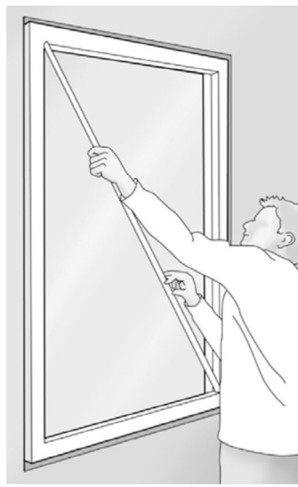
Fig 53. Diagonalmätning är viktig för funktionen hos dörren. Diagonalmåtten skall vara lika.
