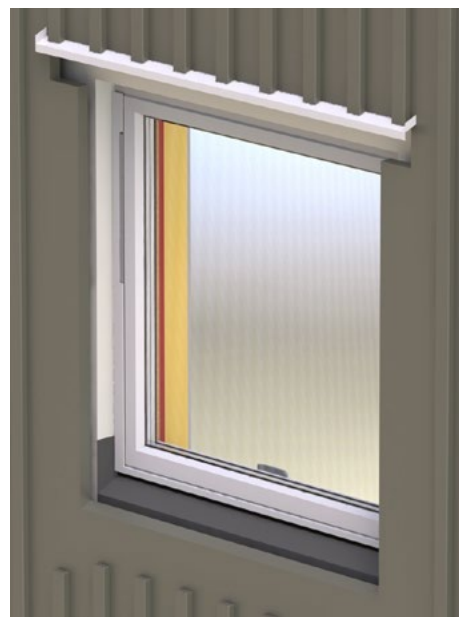
Fig 19. Sekundärtätning går hela fönsterhålets bredd samt 100 mm upp längs sidorna. Tätningen hindrar vatten från att komma vidare in i konstruktionen.
