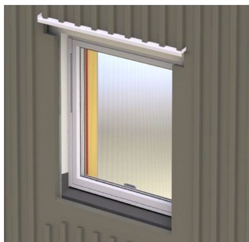
Fig 11. Sekundärtätning dras längs hela fönsterhållets bredd samt 100 mm upp på sidorna. Tätningen hindrar vatten från att komma vidare in i konstruktionen.
