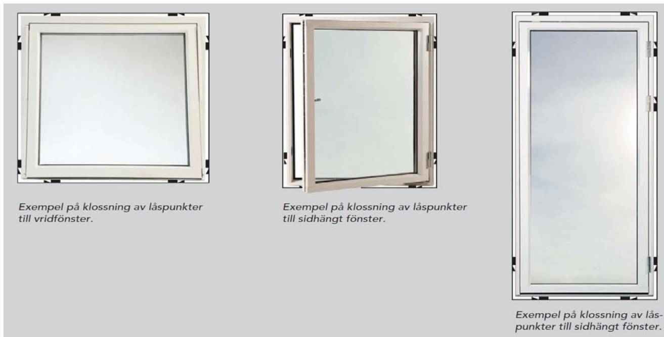
Fig 80. Exempel på klossning av lås- och gångjärnspunkter för fönster och dörrar.
